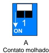
Para alterar as entradas para tipos diferentes de contato, empurre a chave para cima.
